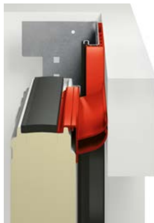
Der optionale Zargenanschluss trennt die Zarge und das Mauerwerk thermisch, so dass die bereits sehr gute Wärmedämmung des Tores um weitere 21 Prozent gesteigert werden kann.
