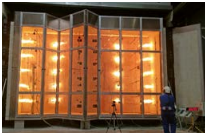
Brandprüfungen sind im ift-Technologiezentrum bis zu einer Größe von 5 x 8 Metern möglich.
