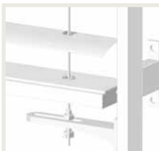
Die erhöhte Windresistenz wird u. a. durch zusätzliche Windlastsicherungen möglich.
