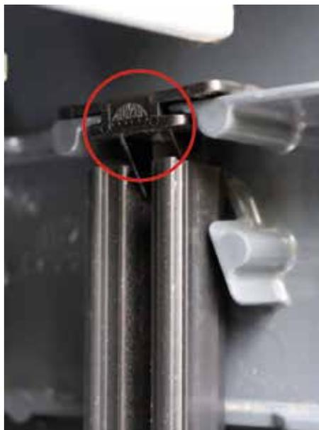
7. In die Blendkappe des Raff-E integrierte Positionierungshilfen sorgen für ein sicheres, präzises und schnelles Ausrichten der Führungsschienen im Kastenbereich und verhindern somit eine nicht-lotrechte Führung der Raffstorelamellen – einer der häufigsten Fehler bei der Montage.
