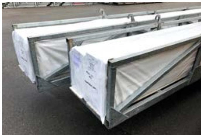
Als versandfertige Sets mit mehreren sechs Meter langen Standardelementen werden die Rollladen-Profile bereitgestellt. Die letzten Zuschnitte verbleiben in der Regie des Kunden, so dass er flexibel und auftragsbezogen agieren kann.
