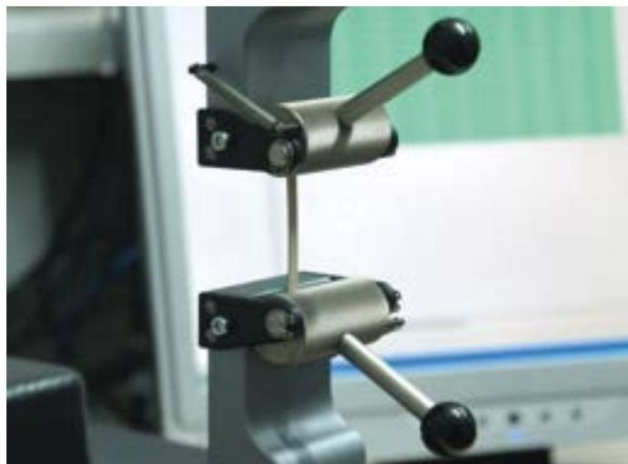
Blick in die Qualitätssicherung des Profilverstellers: Das Bild zeigt eine Universalprüfmaschine, mit der Zugversuche durchgeführt werden.
