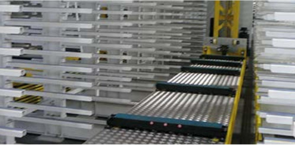
NS Auslagerung von Produkten und Waren – hier kommen auch Paletten-Bediengeräte und Kettenförderer zum Einsatz. Das Automatiklager arbeitet dreidimensional, horizontal, vertikal und seitlich. So lassen sich Ladungen einfach in den Regalgassen hin- und her befördern und in einem bestimmten Regalplatz seitlich ablagern.
