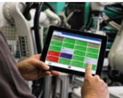
Das Manufacturing Execution System (MES) vernetzt die Spritzgießmaschinen und bietet jederzeit eine Übersicht aller Maschinen.
