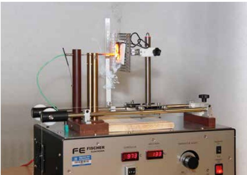
Hier wird eine Glühdrahtprüfung zur Ermittlung der Entflammbarkeit von Bauteilen aus Kunststoff durchgeführt.
