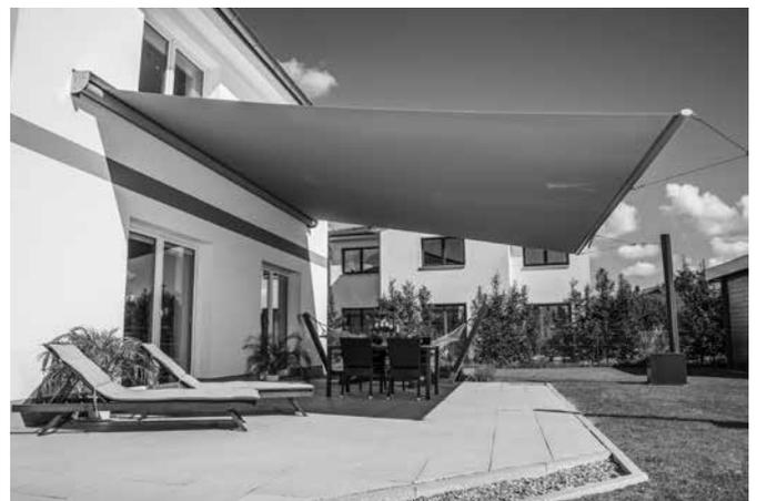
Die Balancerpfosten ziehen mit einer Kraft von jeweils 55 kg das Segeltuch straff und sorgen so für eine extreme Windresistenz. Das Markisensegel ist bequem per Funk fahrbar.
