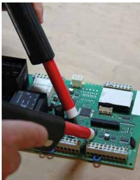
Eine Prüfung der Spannungsfestigkeit elektrischer Bauteile gemäß EN 60335-1 mit der Prüfpistole.
