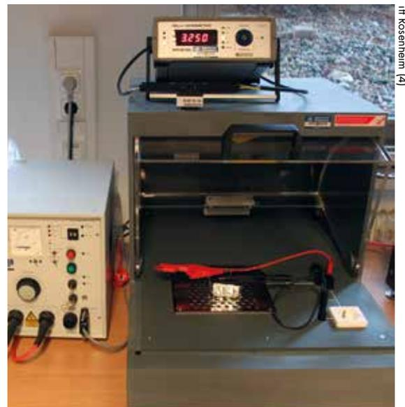
Die Prüfung der Spannungsfestigkeit elektrischer Bauteile gemäß EN 60335-1 im „Prüfkäfig“.
