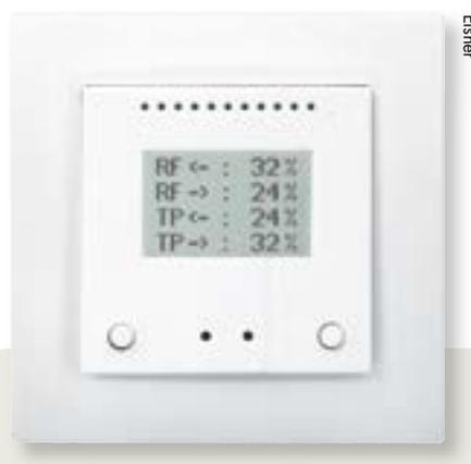
Anwendung findet der Medienkoppler beispielsweise dann, wenn Gebäude nachgerüstet werden sollen, die bereits installierte KNX-Leitung jedoch nicht in alle Bereiche führt.
