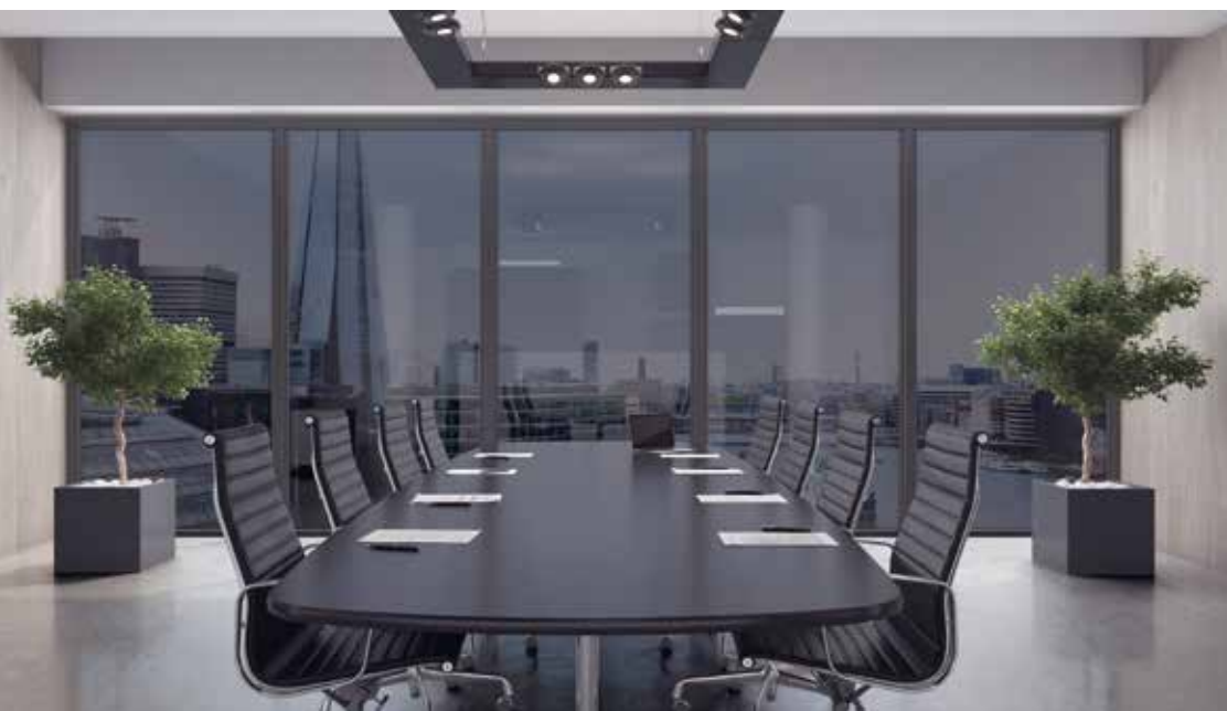
Die dezent graue Einfärbung des Glases lässt sich automatisch durch Sensoren und die Gebäudeleittechnik regeln.
