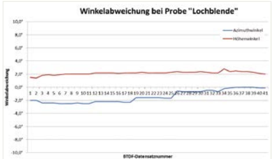
Abbildung 16: Die Gegenüberstellung der Winkelabweichungen zwischen den theoretischen und realen Werten bei der Durchstrahlung einer Lochblende.
