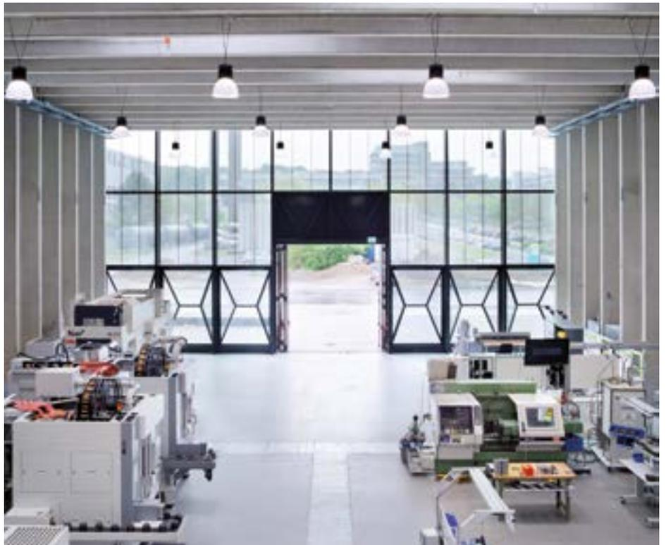
Eine effektive Wärmedämmung verhindert Wärmeverluste, integrierte Verschattungselemente und transluzente Fassadenflächen reduzieren den solaren Energieeintrag und sorgen für ausreichende und blendfreie Tageslichtnutzung.
