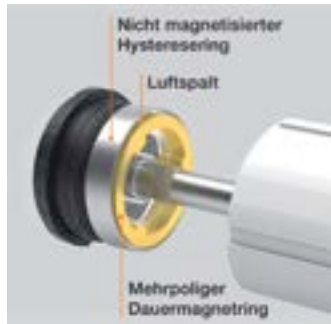
Der Hersteller verbaut in seinen Antrieben bereits seit Jahren eine Hysteresebremse, welche die Behänge vollkommen geräuschfrei stoppt.
