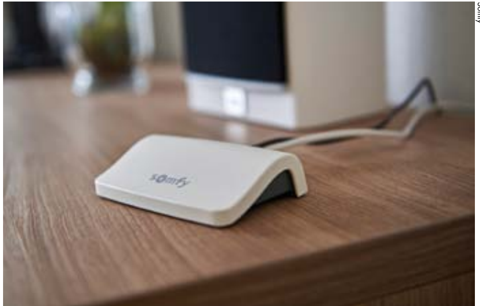
Die elegante Box steuert sämtliche angeschlossene Produkte per Funk.
