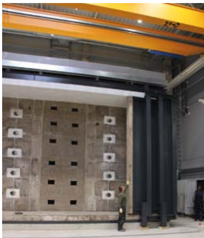
Der 8 x 5 Meter große Brandofen mit Krananlage setzt neue Maßstäbe für Brandschutzprüfungen.
