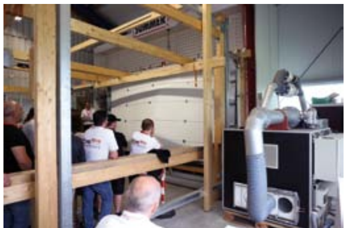
Beim Windlasttest werden extreme Wetterbedingungen simuliert.
