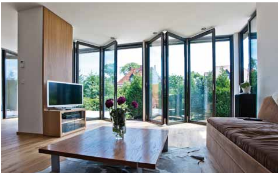
Auch stabil in der Teilöffnung: Die Glas-Faltwände zeigen nach innen und können auch halboffen Frischluft in die Wohnräume lassen.
