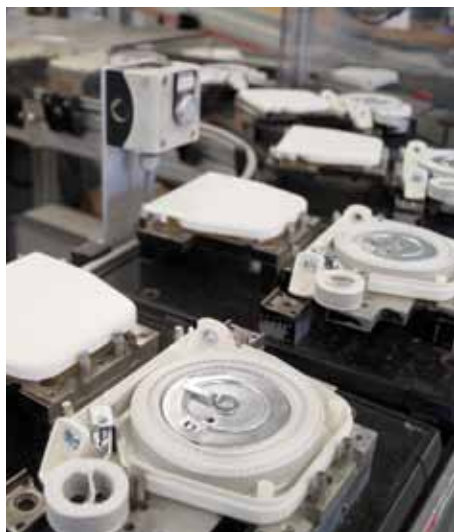
Mithilfe dieses Fertigungsautomaten werden hier Mini-Wickler gefertigt, im Anschluss steht dann die Qualitätsprüfung an.
