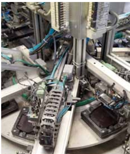
Nach dem Einlegen einzelner Gehäuseteile übernimmt dann der Automat von Station zu Station die Endmontage dieser aufklappbaren Mini-Wickler.
