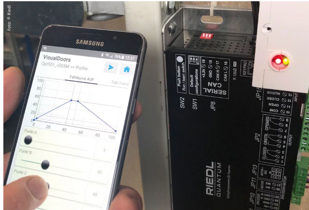
„Einfacher und bequemer kann man eine Kabinentür nicht einstellen“, erklärt Riedl Quantum. "Setting a car door could not be easier and more convenient", according to Riedl Quantum.
