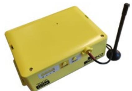
Im Regelfall wird Elseco GSM 9000 mitfahrend auf dem Kabinendach installiert. / Normally, Elseco GSM 9000 is installed on the car roof.
