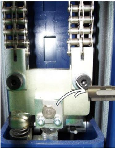
Lastmessbolze im Säulenliftsystem verwendet. / Loadpin used in column lift system.
