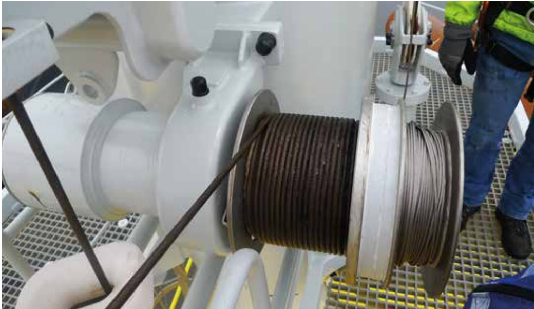
Das Dokumentationsfoto aus einem Prüfbericht zeigt zwei Seilwinden. Ein Seil zeigt erste Spuren von Korrosion, das andere ist nicht korrekt aufgewickelt.
