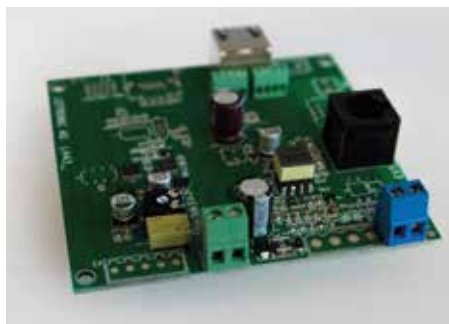
Adapterplatine ermöglicht es, vorhandene Kabinenausrüstung zu verwenden / An adapter board permits using existing car equipment
