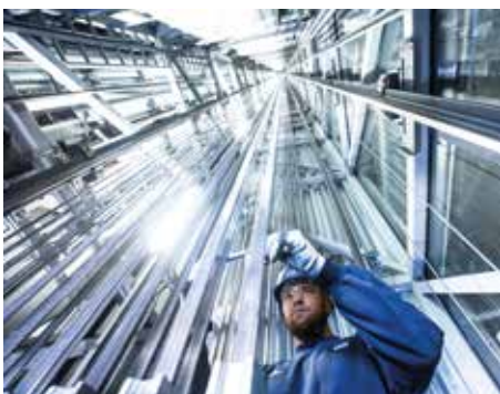
Die elf Testschächte in Tytyri reichen bis in 350 m Tiefe. / The eleven test shafts in Tytyri go down to depth of 350 m.
