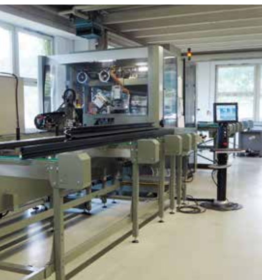
Das Bearbeitungszentrum beherrscht zwölf CNC gesteuerte Achsen zum Bearbeiten von Aluminiumprofilen.
