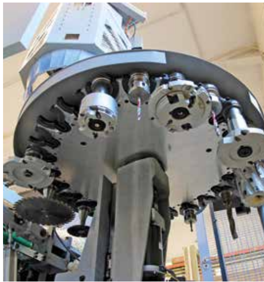
Der 24-fach-Werkzeugwechsler hat genug Platz für die erforderlichen Werkzeuge.
