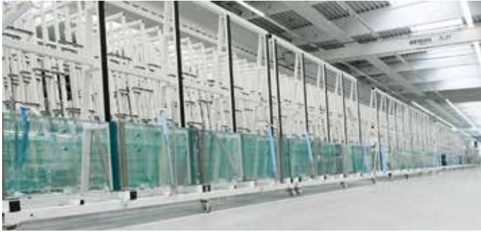
Glasfins mit fünf- bis zehnfachem Glasaufbau in der Fertigung: Sie kommen in Ganzglasfassaden, repräsentativen Foyers oder großflächigen Ganzglasdächern zum Einsatz.
