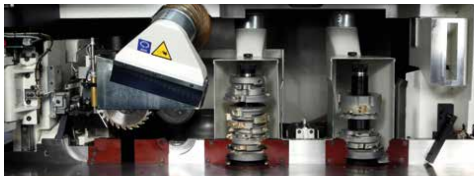
Zur einseitigen Quer- und Längsbearbeitung von Fenster- und Türenkanteln eignet sich die Winkelanlage mit CNC-Steuerung.
