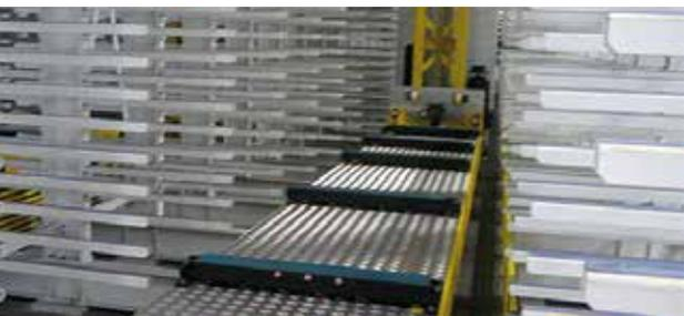
und Kettenförderer zum Einsatz. Das Automatiklager arbeitet dreidimensional, horizontal, vertikal und seitlich. So lassen sich Ladungen einfach in den Regalgassen hin- und her befördern und in einem bestimmten Regalplatz seitlich ablagern.
