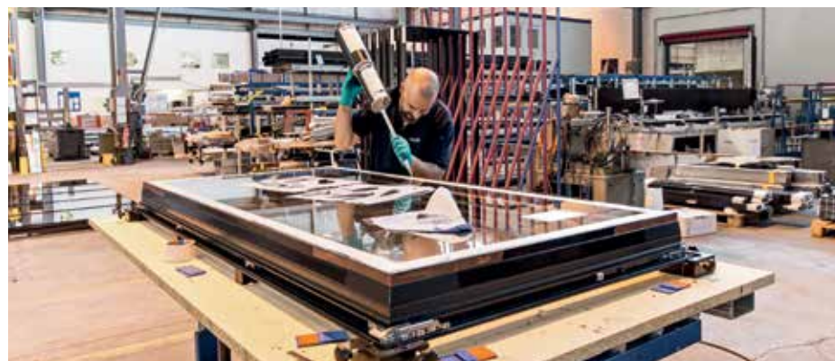
Das eingesetzte Glas wird umlaufend mit dem Rahmen versiegelt.
