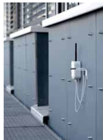
Das gO Mess-System erleichtert die zuverlässige U-Wert-Messung bei Neubau- und Sanierungsprojekten.
