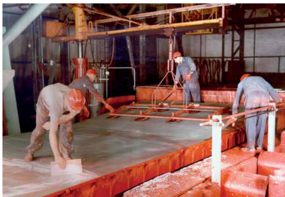
Aufgipsen der Scheibe vor dem Polieren im Vegla-Werk Herzogenrath in den 1950er Jahren.
