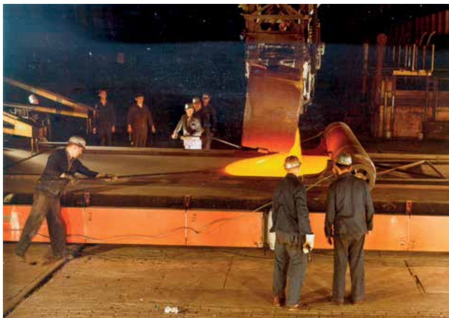
Der traditionelle Tischguss im Vegla-Werk Herzogenrath in den 1950er Jahren
