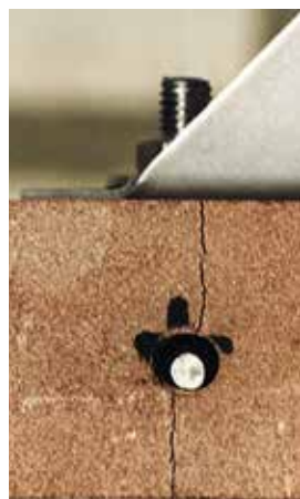
Bild 3: Steckdornbefestigung mit gespaltener Platte.
