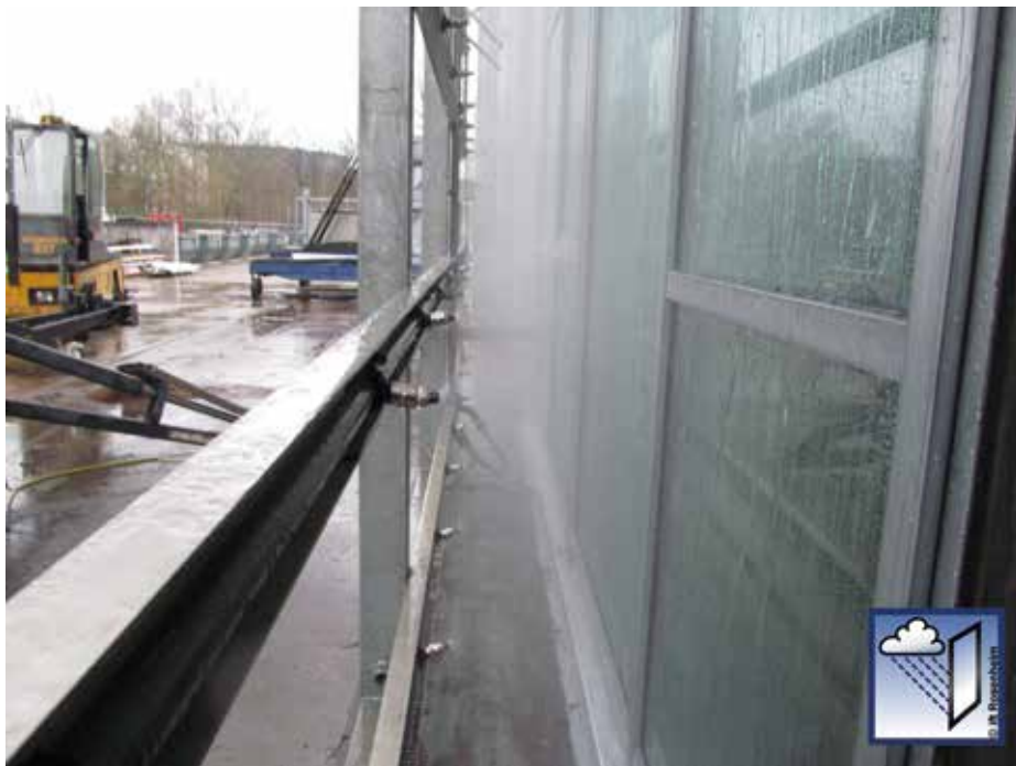
Prüfung der Luft- und Schlagregendichtheit sowie des Windwiderstandes an einem Fassadenelement im ift Prüflabor mit Dokumentation der Kennwerte im ift-Produktpass.
