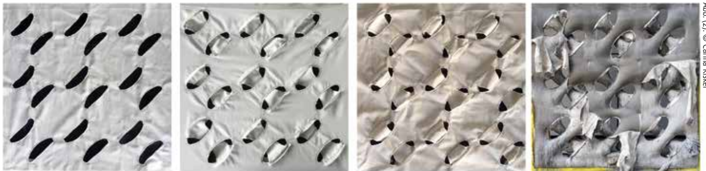
Bild 1: Schrittweise Darstellung zur Fertigung der textilen Schalung.
