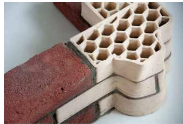
Bild 2: 3D-gedruckter Klinker.
