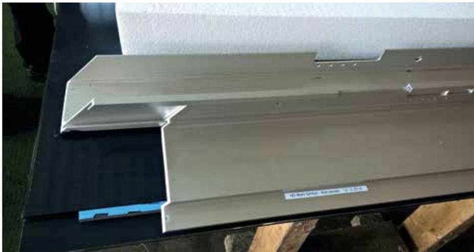
Verklebung des Stufenglasphotovoltaikmoduls mit der Unterkonstruktion.
