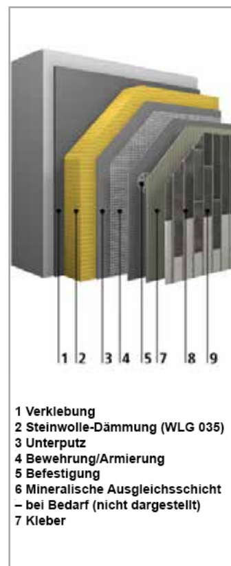
Aufbau des Systems StoTherm Mineral.
