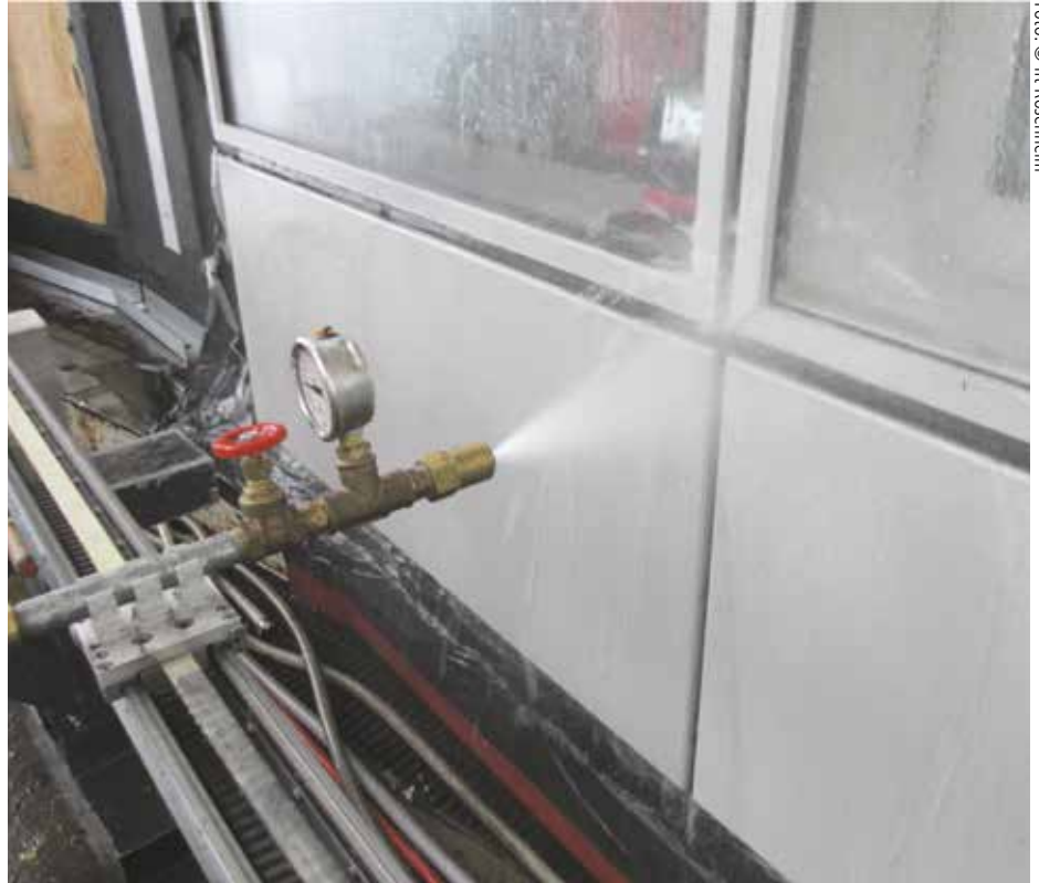
Schlauchtest nach CWCT oder AAMA
