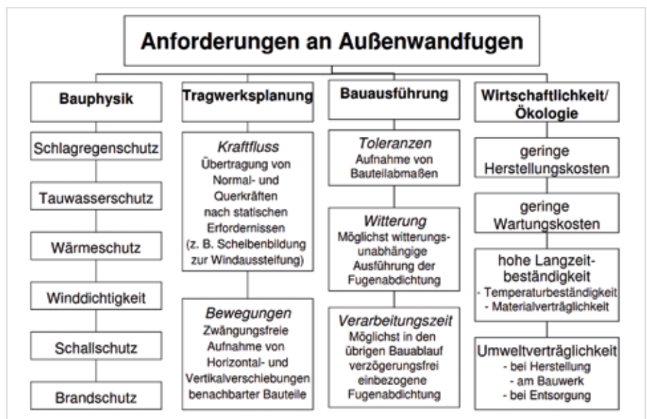
Bild 2: Anforderungen an Außenwandfugen.
