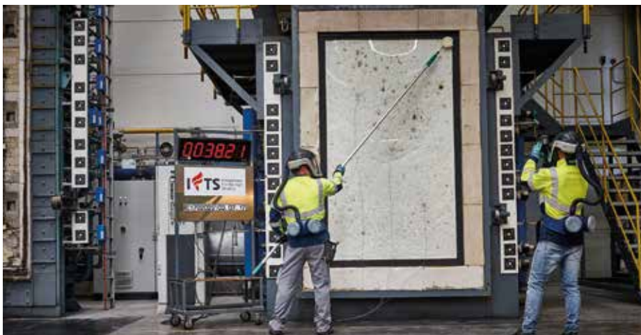
Live-Brandversuch im IFTS: Nach 30 Minuten hat das Bauelement mit Contraflam die Prüfung erfolgreich bestanden.
