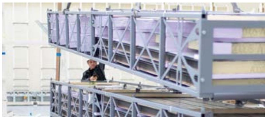
Entsprechend der Montagereihenfolge wurden die GSP-Elemente für den Media Markt in speziellen Transportgestellen verpackt, platzsparend aufeinander gestapelt und sicher miteinander verschraubt.
