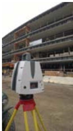
Mit einem 3D-Scanner wird die Gebäudestruktur auf der Baustelle erfasst.
