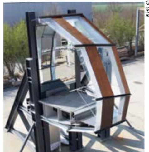
Mock-up-Aufbau auf dem Testgelände von seele in Deutschland in einem vertikal halbierten, drei Meter langen Ausschnitt.
