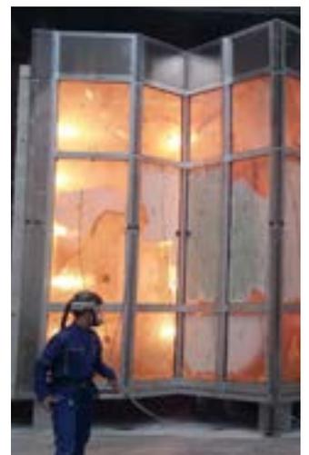
Brandprüfung an Fassadensystem (Hueck) mit verschiedenen Eckpfosten und „Bleckecke“.
