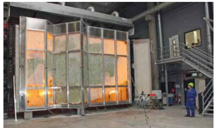
Hueck-Brandschutzfassade als Sonderkonstruktion mit Eckwinkeln im 8 x 5 Meter Brandofen im ift-Technologiezentrum
