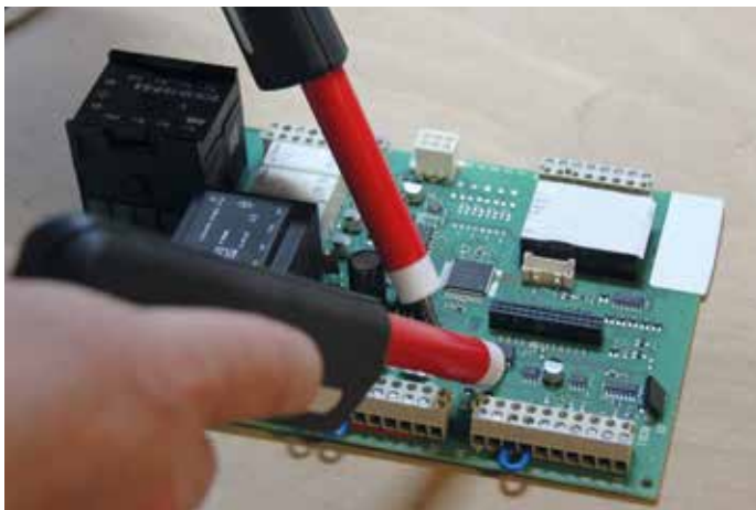
Prüfung der Spannungsfestigkeit elektrischer Bauteile gemäß EN 60335-1 mit der Prüfpistole.
