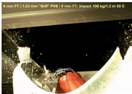
Bild 3: Laminat mit steifem PVB wird durchgeschlagen.
