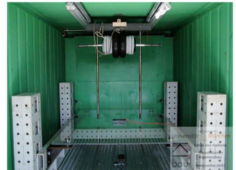
Bild 4: Versuchsaufbau zur Messung der Resttragfähigkeit nach Glasbruch.
