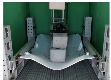
Bild 7: Das Laminat mit 1,52 mm dicker Ionomer-Zwischenlage versagte bei 300 kg/50 °C.
