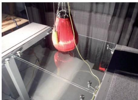
Bild 2: Statische Belastung einer rahmenlos punktgehaltenen Scheibe für ein Vordach.
