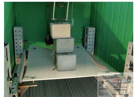
Bild 5: Das Ionomer-Laminat mit 400 kg Belastung bei 21 °C.
