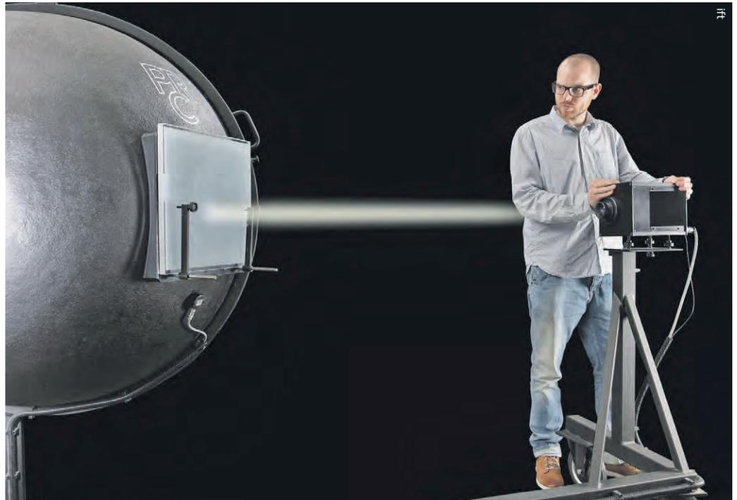
Auf der Messe wird u.a. die sog. Ulbrichtkugel gezeigt, mit der auch veranschaulichende Prüfungen durchgeführt werden. Sie misst Lichttransmissions- und -reflexionsgrad.
