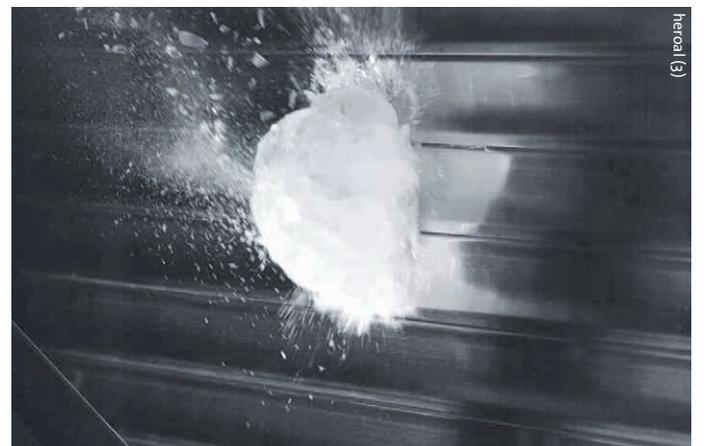
Test unter Echt-Bedingungen: Rolltorschysteme werden mit Eiskugeln aus einer Hagelsimulationsmaschine beschossen und auf ihre Hagelresistenz geprüft. / *Tested under genuine conditions: roller door systems are bombarded with ice pellets by a hail simulation machine and tested for their hail resistance.*
