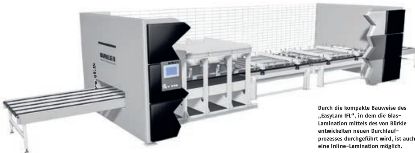
Durch die kompakte Bauweise des „EasyLam IFL“, in dem die Glas-Lamination mittels des von Bürkle entwickelten neuen Durchlaufprozesses durchgeführt wird, ist auch eine Inline-Lamination möglich.
