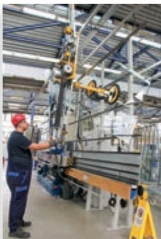
**l.:** Bis zu 800 kg trägt der Vakuumheber 7441-DSG-BAL, der auch für gebogene Elemente eingesetzt werden kann.
