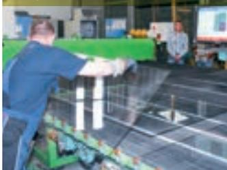
Der „Easylam IFL“ von Bürkle laminiert im Durchlauf Verbundgläser und bietet im Vergleich zur Autoklav-Laminierung klare Effizienz- und Kostenvorteile.
