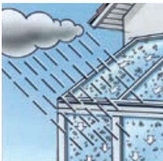
Aufgrund der hydrophilen (Wasser anziehenden) Eigenschaft der Beschichtung breitet sich Regenwasser als Film auf der Glasoberfläche aus, wodurch gelöste Schmutzpartikel entfernt werden.
