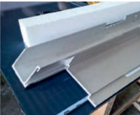
Der Stufenaufbau erlaubt die unabhängige Verklebung der Front- und der Rückscheibe auf der Unterkonstruktion, sodass die Lastabtragung aufgeteilt wird.
