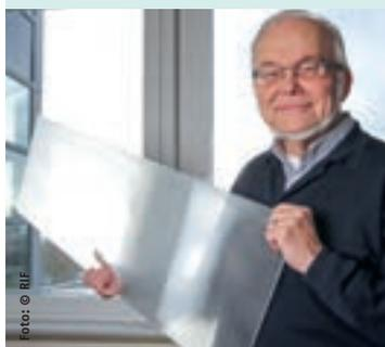
Sieht aus wie „Milchglas“, kann aber weit mehr: Im Forschungsprojekt TaLED konnte Prof. Andreas Neyer mit seinen Mitarbeitern Prototypen aus dem RIF-Labor bereits bis zur Produktionsreife entwickeln. Das Spezialglas lenkt Tageslicht in Räume und ergänzt es bei Bedarf mit LED-Licht.
