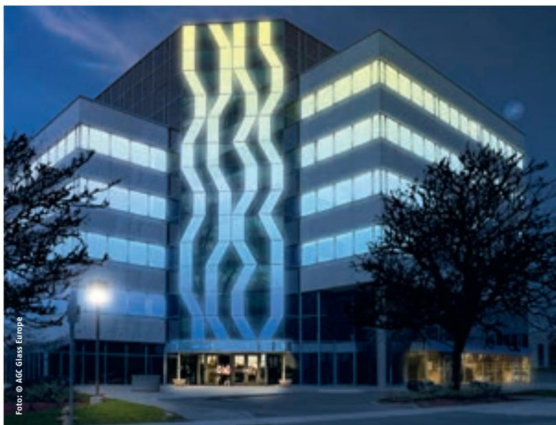
Beim Aktivglas „Glassiled Uni“ sind RGB-LEDs unsichtbar in der Rahmenkonstruktion untergebracht, die die gleichmäßige Illumination von Teilen der Fassade ermöglichen. Am Tag sind die Scheiben optisch nicht von normalen Verglasungen zu unterscheiden.
