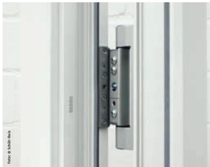
Ronda Ratio 3D wird im Überschlag verschraubt. Die Montage gestaltet sich einfacher, die Dichtungsbänder können ohne Unterbrechung um den Rahmen geführt werden.
