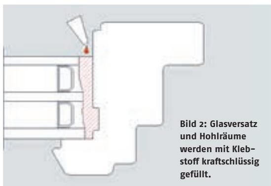
**Bild 2:** Glasversatz und Hohlräume werden mit Klebstoff kraftschlüssig gefüllt.
