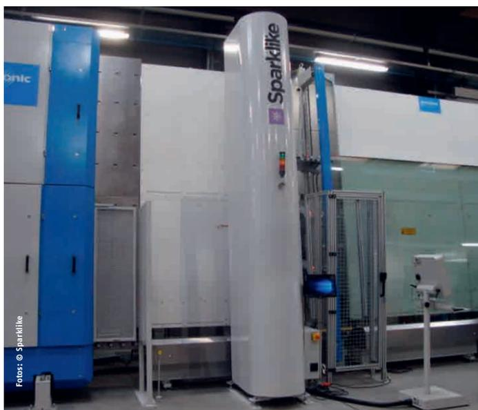
Das neue Sparklike Online-System zur Gasprüfung lässt sich individuell an Isolierglaslinien anpassen und ist an Zwei- und Dreifach-Aufbauten mit Beschichtungen und Laminaten einsetzbar.
