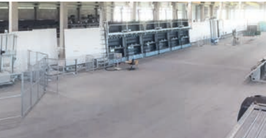
Imposante Gesamtansicht der 165 Meter langen Isolierglaslinie Bystronic glass B'Jumbo XXL.
