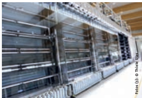
Halbautomatische Rahmensetzstation frame-posititioner für Rahmen bis zu 18 Meter Länge
