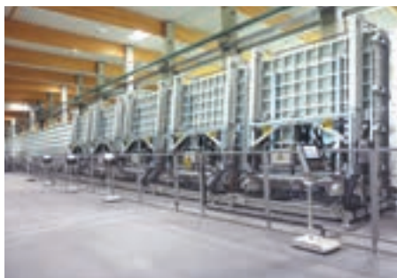
B'Jumbo_XXL_assembler: die fünf Zusammenbau-, Gasfüll- und Pressautomaten
