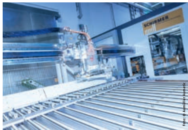
Das neue Bearbeitungszentrum von Aumüller Aumatic produziert pro Jahr bis zu 150.000 Aluminiumgehäuse für Fensterantriebe.
