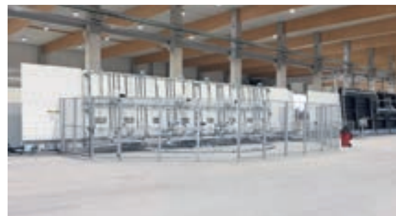
B'Jumbo_XXL_turner: integriertes Drehband für Gläser bis zu 12 Meter Länge
