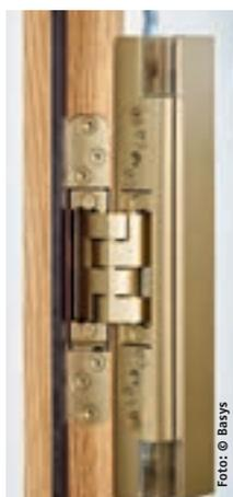
Herzstück der Bandserie ist das patentierte Konstruktionsprinzip aus einem symmetrischen Vier-Arm-Gelenk, das die Kräfte des Türflügels gleichmäßig in die Zarge leitet.
