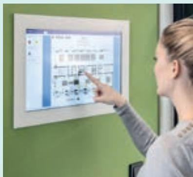
Mit jedem IP-fähigen Gerät – PC, Tablet, Smartphone oder Touch Panel – kann man auf die Informationen von Geze Cockpit zugreifen. Mit jedem System sind bis zu 62 Geze-Produkte auf Basis von BACnet IP vernetzbar.
