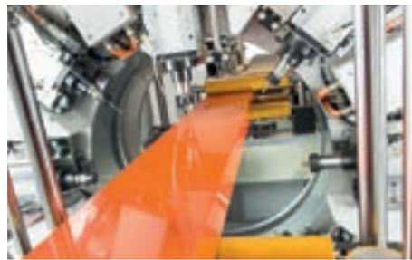
Bearbeitungsbereich und die HSK-C 40 Werkzeugaufnahme ermöglichen ein schnelles Umrüsten der Maschine.
