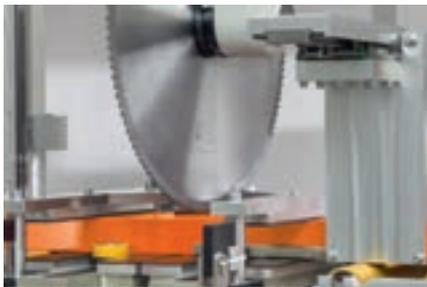
sind auch ziehende sowie Stech- und Klinkschnitte möglich. Hierbei fixieren die Plattenspanner das Werkstück absolut zuverlässig, denn durch ihre schmale Ausführung lässt sich der mittels einer Servo-Achse stufenlos verstellbare Spannabstand extrem verkürzen. Die absenkbaren Tischplatten gewährleisten einen störungsfreien Profiltransport.
