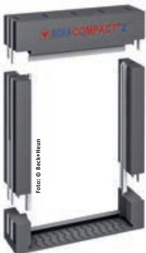
Für den einfachen Transport auch besonders großer Elemente wird Roka-CO2MPACT 2 in vier Einzelteilen geliefert und an der dafür vorgesehenen Mauerwerksöffnung zusammengesteckt.
