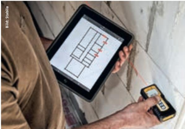
**Laser-Entfernungsmesser LD 250 BT und LD 520 mit Bluetooth Technologie: Messwerte einfach kabellos übertragen und dokumentieren.**
