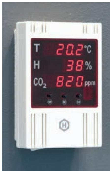
Der Multisensor Hautau MS überwacht Temperatur, Luftfeuchtigkeit und CO<sub>2</sub>-Gehalt und leitet bei Abweichungen von den Soll-Werten Maßnahmen ein.
