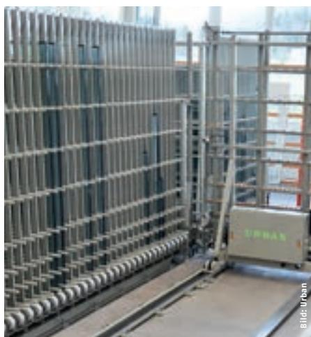
Barcode-gesteuert erhält jedes Isolierglaselement bereits während der Fertigung eine eindeutige Position im Glaspuffer des Fensterbauers.
