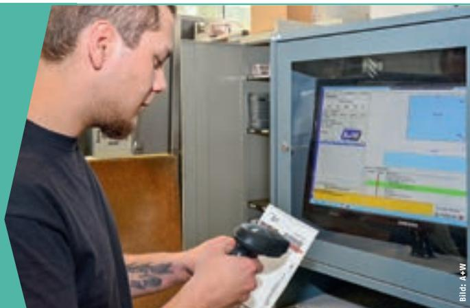
Mit einer Barcodelesung holt sich der Maschinenführer an einer CNC-Bohrmaschine die Daten auf den A+W Produktionsmonitor. Programmieraufwand hat er nicht. Die Programmierung erfolgt automatisch.
