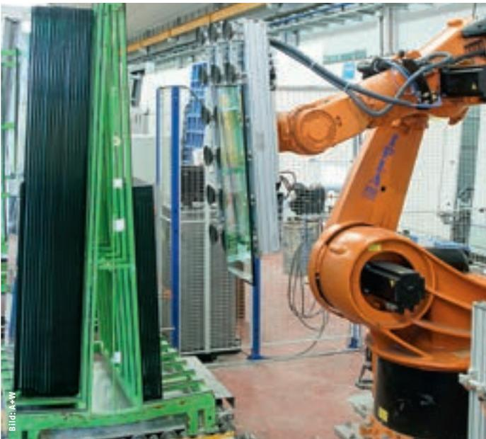
Industrie 4.0 – eine langfristige Entwicklung: Vollautomatische Verpackung in Wunschsequenz am Ende der Isolierglas-Linie im Jahr 2008.
