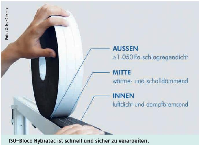
ISO-Bloco Hybratec lässt sich einfach, schnell und sicher verarbeiten. Das vorkomprimierte Band aus imprägniertem PUR-Weichschaum ist mit einer einseitigen Selbstklebung zur Montageunterstützung ausgestattet. In nur einem Arbeitsschritt wird das Band am Fensterahmen angeklebt. Gegenüber der konventionellen Fenstermontage mit Folien kann sich die Arbeitszeit auf weniger als ein Viertel der Zeit verkürzen, unterstreicht ISO-Chemie.
