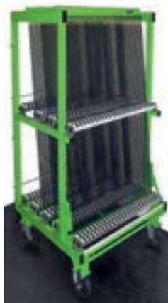
Zwei Ebenen, mehr Fächer: Der Hegla Doppelstockfächerwagen BF 50 10 ND hält bis zu 100 Scheiben oder Bleche im direkten Zugriff bereit.
