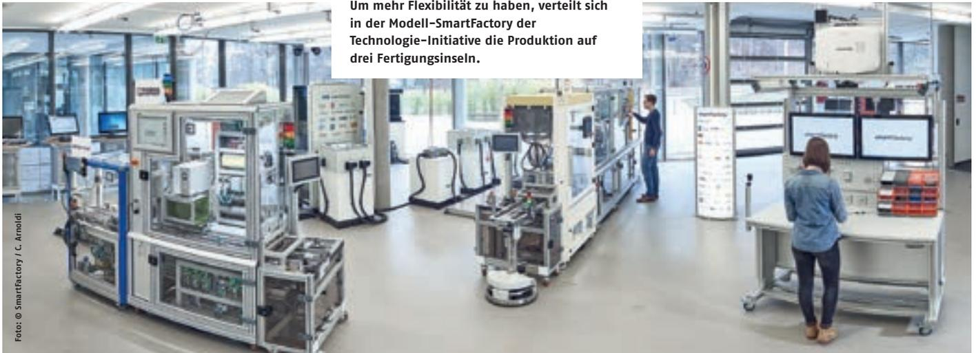
Um mehr Flexibilität zu haben, verteilt sich in der Modell-SmartFactory der Technologie-Initiative die Produktion auf drei Fertigungsinseln.
