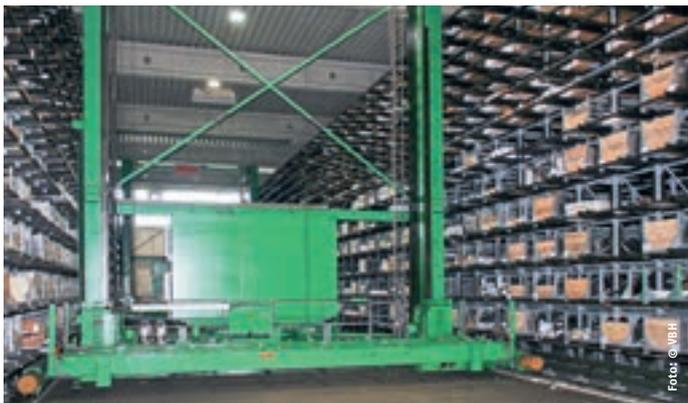
Das Hochregallager am Standort Ilsfeld bietet Platz für 1.300 Kassetten mit Langgütern bis sechs Meter Länge. Insgesamt sind mehrere tausend Artikel für den Holz-Metall-Bereich bei VBH ständig tagesaktuell verfügbar.
