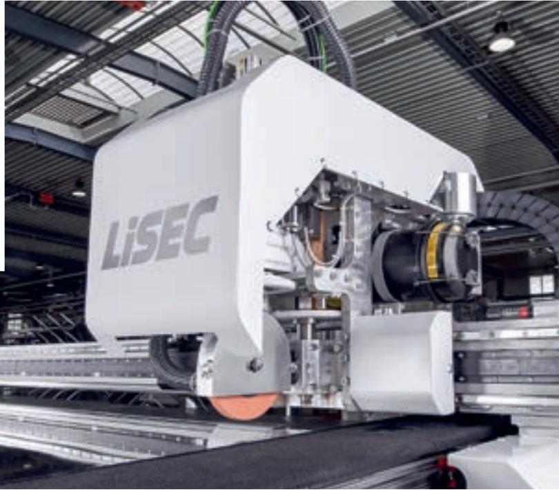
Die neue SprintCut ist laut LiseC derzeit die schnellste Zuschnittanlage für Flachglas. Durch niedrige Wartungsintervalle ergeben sich für den Nutzer zudem geringe Stillstandskosten, erklärt das Unternehmen.
