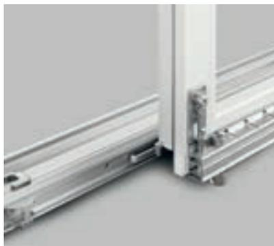
Das Bild zeigt den Laufwagen mit einem Verstärkungsteil, das als stabilisierende Verbindung ab Flügelgewichten von 100 kg eingesetzt wird. Zur Optimierung des Ein- und Auslaufens lässt es sich einfach mit einem Torx-Schlüssel verstellen.
