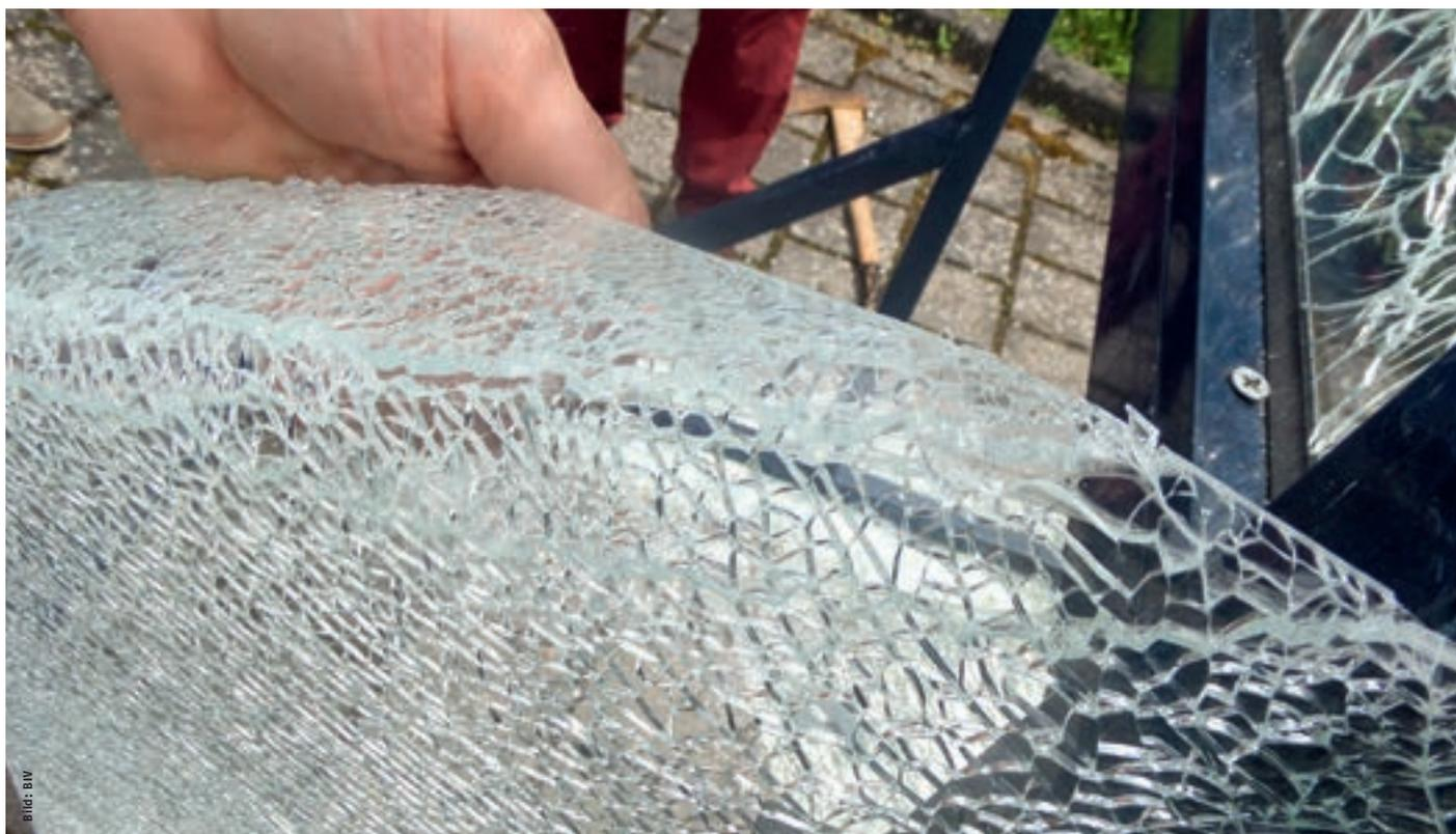
Bei einer großflächig mit Folie beklebten ESG-Scheibe kommt es im Falle eines Bruchs aufgrund der vollständig anhaftenden Glasstücke zur Schollenbildung. Diese kann als ganze Einheiten herabfallen, wodurch das Verletzungsrisiko deutlich erhöht wird.
