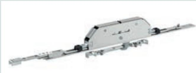
Das Null-Millimeter-Schwelensystem wird mit dem neuen Hakenverschluss Multi Zero möglich. Zudem bietet er bei verschlossenem und in gekipptem Flügel ein hohes Sicherheitsniveau. Der Haken greift jeweils in die Schwelle und verhindert so ein Aushebeln. Wird die Fenstertür geöffnet, verschwindet der Doppelhaken im Fensterfalz.
