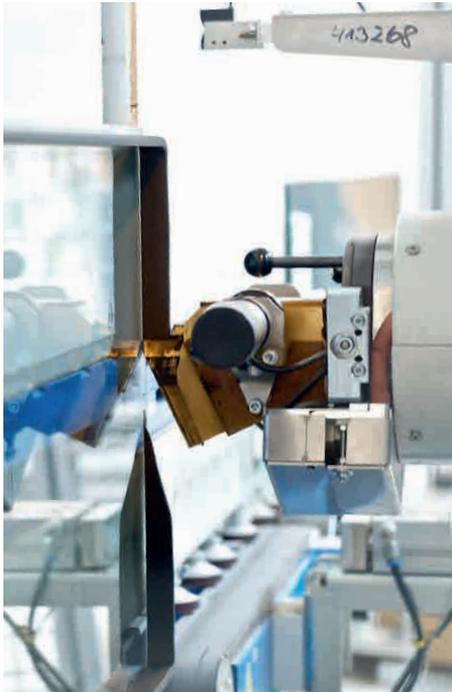
Links: Eine vollautomatisierte Fertigungslinie mit Applikator und einem einzigen Dichtstoff aus dem Fass macht die Produktion von Isoliergläsern mit Warmer Kante hocheffizient.
