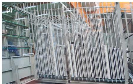
(3) Über Einführungsschächte gelangen die Elemente aus dem Puffer in die jeweiligen Bearbeitungsbuchten.
