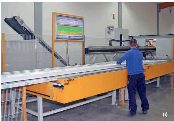
(1) Ein Mitarbeiter bestückt das Schirmer-Vorlegemagazin und den legt zwischenzeitlich Stahlprofile in das benachbarte Magazin für die Stahlbearbeitung ein.
