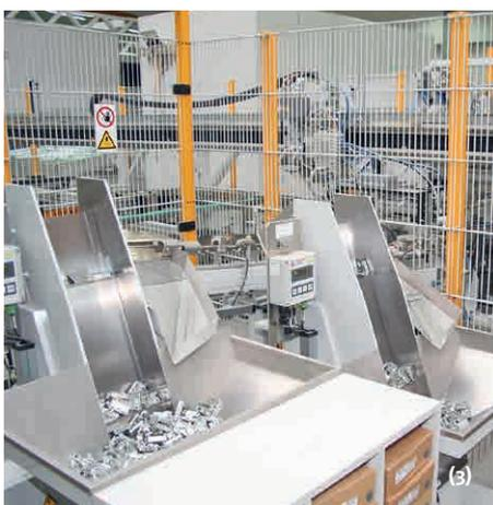
(3) Schließteile, wahlweise mit oder ohne Merschmann-Logo, werden vollautomatisch verschraubt.
