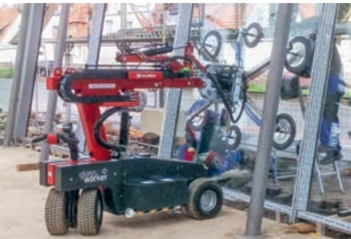
Der wendige und geländegängige Glassworker GW 625 ist eine Eigenentwicklung von Uplifter. Der Glaslifter besitzt eine Tragkraft von 625 kg (bei 1,4-facher Standsicherheit) und ist für die vertikale Montage bis 3,10 Meter und die Überkopfmontage bis 3,60 Meter ausgelegt. Das Gerät ist mit einem selbstüberwachenden Sicherheitssystem ausgestattet und bietet serienmäßig eine Funkfernbedienung für Hebearm und Sauganlage. Die Sauginheit ist frei konfigurierbar.
