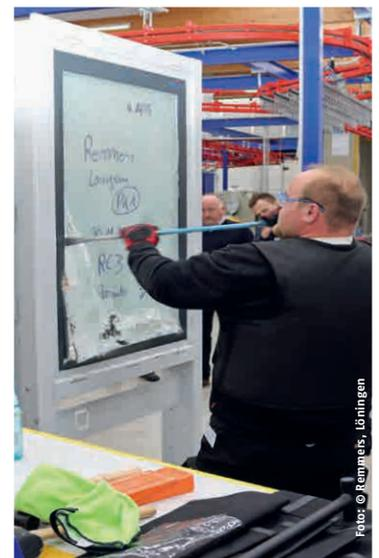
An einem Demonstrationsobjekt wurde ein Einbruch simuliert.
