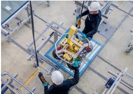
Speziell für ein Projekt entwickelte seele drehbare Montagetische für den Zusammenbau.
