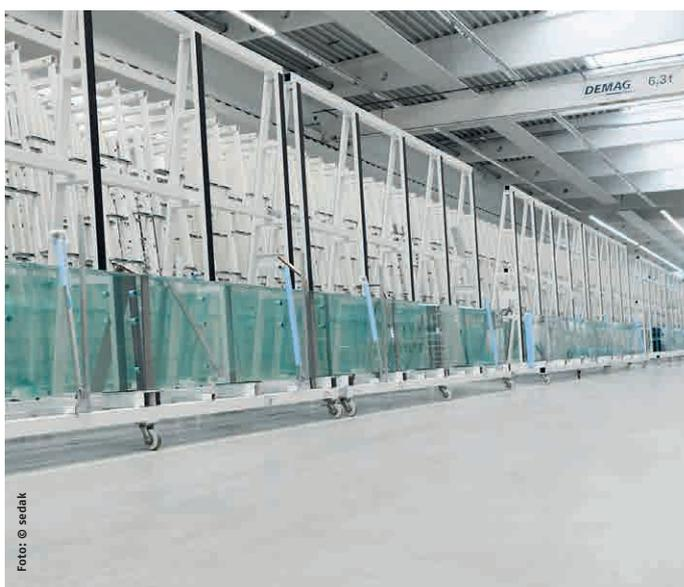
**sedak kann Glasfins bis zu einer Länge von 20 Metern fertigen. Ein 17,8 Meter langes und 1,5 Tonnen schweres Exemplar ist auf der BAU zu sehen.**
