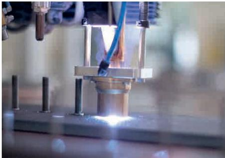
Mit der Bolzenschweißanlage können pro Stunde bis zu 1.000 Bolzen aufgeschweißt werden.
