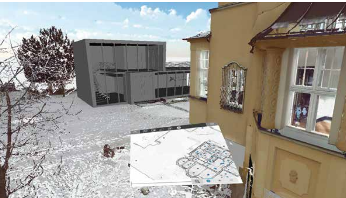
3D-Scandaten und CAD-Modell sind kombiniert darstellbar.
