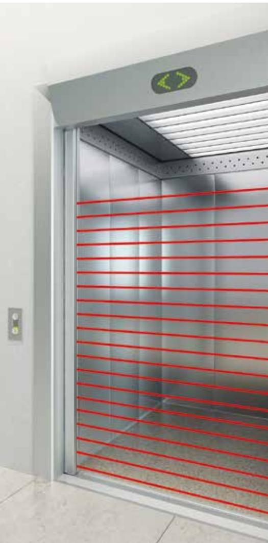
Um eine sichere Erkennung von Objekten ab 50 mm zu gewährleisten, wird der Türbereich alle 46 mm mit Parallelstrahlen überwacht. Damit wird die Forderung aus der EN81-20 bis 1600 mm im gesamten Schließbereich durchgängig erfüllt, ohne auf den Abstand von Sender- zu Empfängerleiste achten zu müssen. DUOmetric hat auf die günstigeren Diagonalstrahlen verzichtet, um die Aufzugplanung zu erleichtern.
