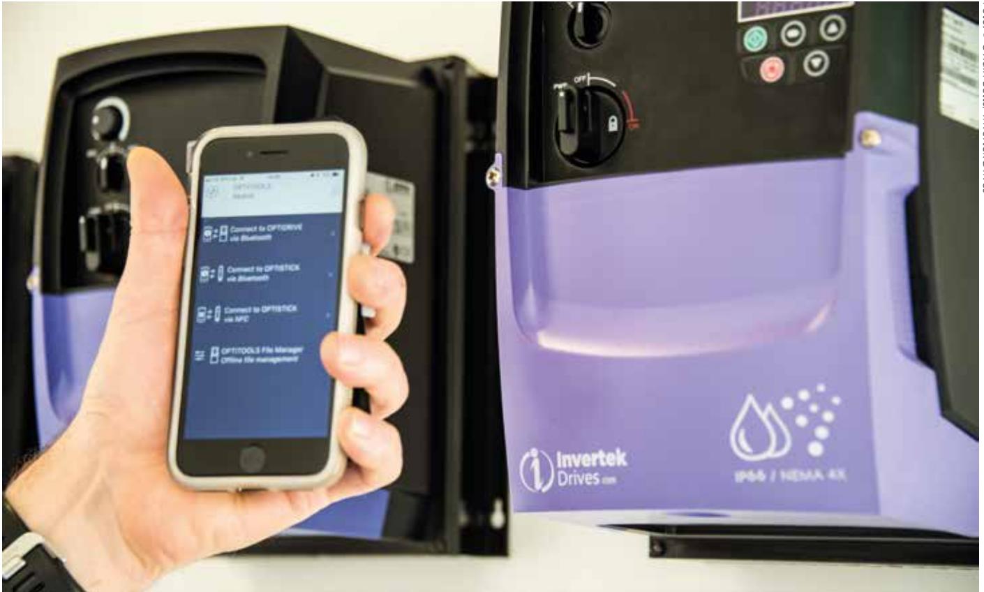
Die OptitoolsMobile-App kann zusammen mit dem OptistickSmart verwendet werden. The OptitoolsMobile app which can be used with the OptistickSmart.
